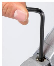
アーム上下稼働の調整ボルトは硬めで固定されています。取付けるモニター/操作盤の重量に応じてボルトを緩めて使用して下さい。
